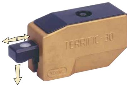
Bride compacte à came rétractable pour pièces de série qui doivent pouvoir être dégagées rapidement. Utilisation avec tables à rainures de largeur 12 à 22 mm (avec ou sans cales) et pour plateaux à trous taraudés M12, M14 et M16 (seulement sans cales).
