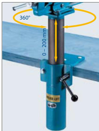
L'adaptation de l'étau à la taille de l'utilisateur est important – élever et pivoter. L'étau se laisse ajuster aisément et graduellement dans une position de travail en toute sécurité jusqu'à une hauteur de 200 mm avec une rotation de 360°. Grâce au ressort à gaz l'étau se règle sans effort dans la position de travail souhaitée
