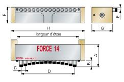
Les flancs de fixation et les cales livrés avec chaque "FORCE" permettent une adaptation aux différentes largeurs d'étaux
