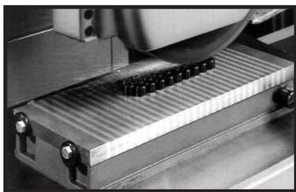
Plateau rectangulaire à aimants permanents et à carcasse monobloc, plaque polaire assemblée à la brasure d'argent, champ magnétique : 8 mm, double circuit magnétique à aimants en céramique dans un bain d'huile pour diminuer considérablement la rémanence. Ces modèles peuvent être utilisés avec les barres répartitrices de flux magnétique (voir pages 300 - 301).
