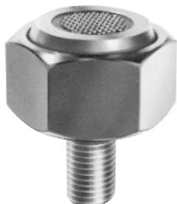
La pièce à usiner repose sur des billes tronquées qui peuvent s'orienter librement dans leur logement en s'adaptant ainsi au contour de la pièce à usiner. Les 4 grandeurs de billes ( $\varnothing$  8 / 12 / 24 / 40 mm) s'adaptent sur des unités de serrage afin de répondre à pratiquement toutes les tailles et tous les poids des différentes pièces à usiner.
