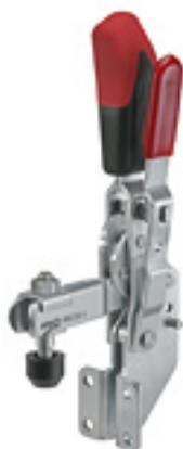
Le verrouillage de sécurité bloque le bras de la sauterie en position fermée ou ouverte. Ce verrouillage évite les ouvertures ou fermetures intempestives dues à des vibrations, des montages tête en bas ou de faux mouvements de l'utilisateur.
