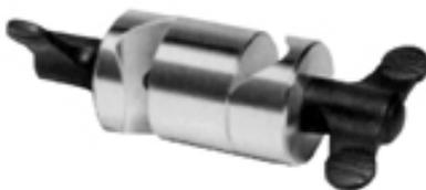
**MATIERE** : écrou-papillon de serrage en thermoplast anthracite mat, tige filetée en acier 5.8, bruni, bloc de serrage en aluminium de haute résistance anodisé argent.
