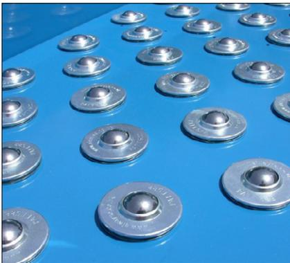
Une bille porteuse ou de manutention remplace le frottement par un roulement et permet donc une économie d'efforts et de temps. La parfaite rotation des billes permet de déplacer des charges mêmes lourdes dans toutes les directions jusqu'à des vitesses de 2 m/sec. La bille porteuse se compose d'une bille roulante de gros diamètre roulant sur un lit de petites billes en acier roulant elles-mêmes dans une cuvette hémisphérique contenue dans un carter.
