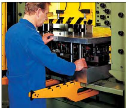
Ces consoles à rouleaux en acier trempé sont utilisées par paire pour pouvoir déposer les outillages à la hauteur de la table de la presse. Elles sont accrochées à cette table et forment un complément idéal aux «rollblocs» disposés dans la table. La pose et la dépose des outillages peut s'opérer par gerbeur ou chariot élévateur puisqu'on travaille entièrement en porte-à-faux.
