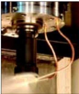
Ces adaptateurs pour trous lisses permettent d'obtenir plus de précision et plus de pression à l'endroit désiré.
