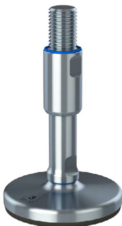
Pied Ref. NAN.XHGS massif pour une charge max. de 11.000 daN – Ø 105 / 125 / 150 mm.
