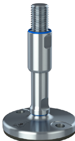
Pied Ref. NAN.XHJS massif avec 2 trous pour fixation au sol et pour une charge max. de 11.000 daN – Ø 105 / 125 / 150 mm.
