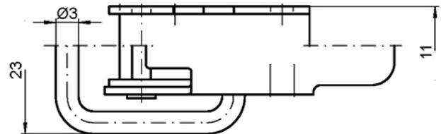
**Modèle long Type 13 – avec trous de fixation Ø 3,3 mm :**
