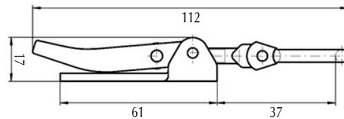
Modèle type 20 avec trous de fixation Ø 4,2 mm :
