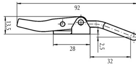
Modèle type 21 réglable avec trous de fixation Ø 4,2 mm :
