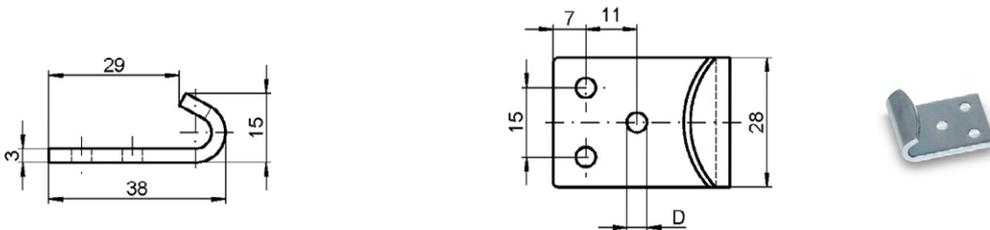
Crochet – longueur 78 mm avec 3 trous de 5,4 mm :
