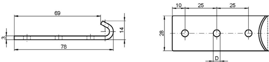
Crochet – longueur 103 mm avec 3 trous de 5,4 mm :
