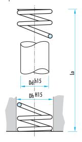
Si le ressort n'est pas précontraint, il peut y avoir des auto-oscillations lorsque le ressort est sous charge.
