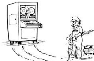
L'**isolation passive ou indirecte** doit protéger le matériel sensible tel que balance, appareil de mesure contre les vibrations et les chocs transmis par les fondations. Elle dépend donc de l'environnement.
