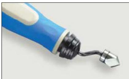
Cette méthode «**Rotodrive**» est la plus rapide pour chanfreiner des alésages à la main, grâce au système de manivelle.
