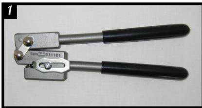
Corps et leviers en acier peint en gris martelé, les extrémités des poignées sont munies d'une gaine de caoutchouc noir permettant une bonne "prise". Les sets poinçon-matrice en acier trempé, sont interchangeables et peuvent être rectifiés par la suite.
