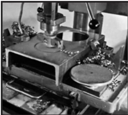
Ces appareils sont fournis avec une tige d'attachement pour foreuse et permettent de découper des tôles de différentes matières.
