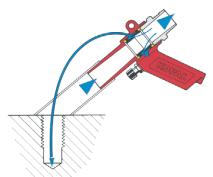
Ce pistolet en matière plastique se relie directement au réseau d'air comprimé et utilise le principe d'écoulement d'air "venturi".
