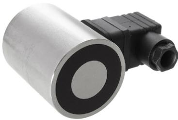
Ventouse munie d'un aimant permanent. L'attraction et le maintien sont réalisés sans courant. La pièce est libérée et décollée sous tension.
