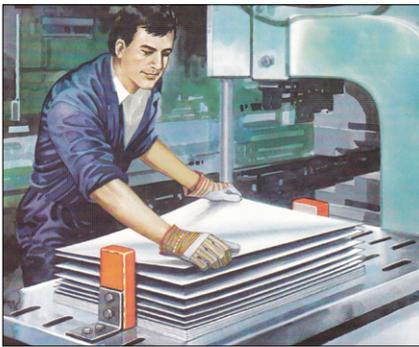
Ces écarteurs à aimants permanents en ferrite ont été développés pour soulever les tôles en acier d'une pile couchée ou dressée. La distribution du champ magnétique de ces séparateurs permet d'éviter le contact des tôles l'une contre l'autre et les sépare une à une.
