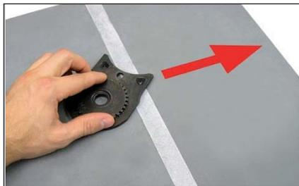
Appareil robuste avec une profondeur de démagnétisation de 10 mm. Le champ magnétique alternatif est situé au milieu du plateau, les deux sections à droite et à gauche forment les pôles opposés.
