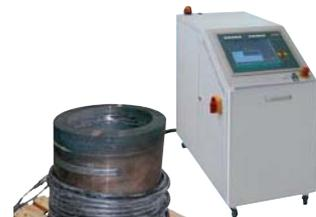
Le magnétisme résiduel ou rémanence provient de sources multiples : usinage sur plateau magnétique, préhension par aimant de levage, usinage de pièces (fraisage, poinçonnage, estampage, frittage), détection de fissures, stockage...
