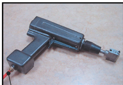
Alimentation en air comprimé (6 à 10 bar)
