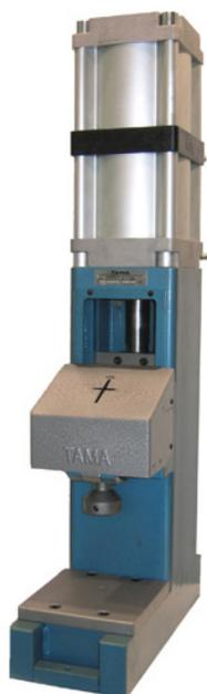
Ces presses sont réalisées en profilés d'acier et peintes en bleu ou gris martelé. Elles fonctionnent suivant le principe du 'levier' interne avec une force pratiquement constante tout au long de la course. La course est réduite : de 8 à 13 mm selon les modèles et il n'y a ni réglage de la course ni réglage de la hauteur de travail. Le réglage de la force peut se faire par un régulateur pneumatique (non fourni).
