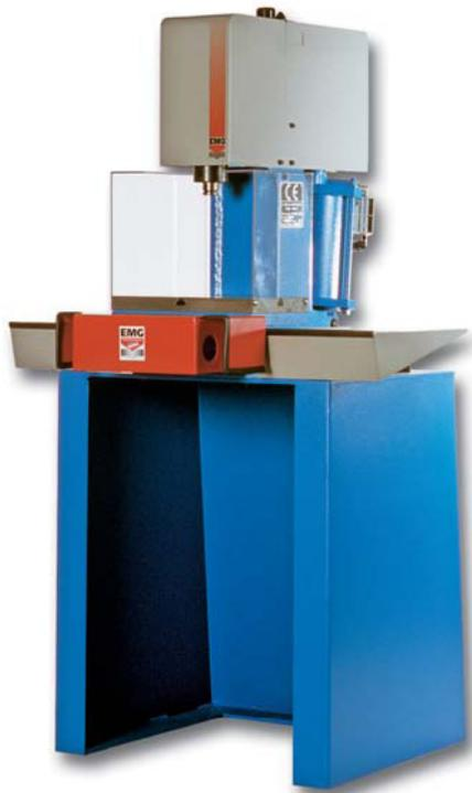
Presse à cylindre pneumatique double effet, actionnant un levier qui agit sur le coulisseau. Cette presse possède une force constante tout au long de la course et peut servir aussi bien pour des opérations de montage, d'assemblage que pour des découpes ou du petit emboutissage.
