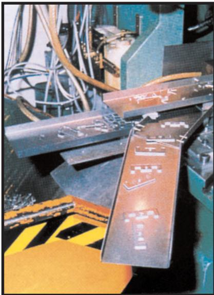
Spécialement conçu pour utilisation avec des presses et des automates de poinçonnage. Cet appareil évacue par vibrations les pièces estampées, les déchets d'estampage ou des pièces diverses. Très compacte, la goulotte adaptée aux besoins peut être introduite jusqu'en dessous des poinçons.
