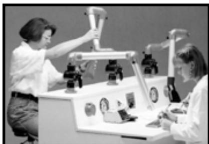
Pour répondre à des problèmes légers de pollution comme : fumées de soudure, de brasure, particules, vapeurs et odeurs dans les industries chimiques, électroniques, les laboratoires. Les deux modèles résistent à la plupart des solvants, huiles, acides...
