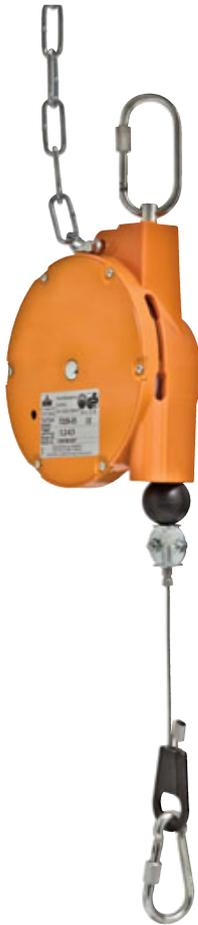
Le ressort est enroulé sur une poulie conique, le câble reste en position après utilisation.
