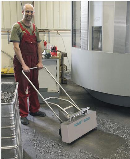
Permet le ramassage de copeaux, clous, petites pièces ferreuses.
