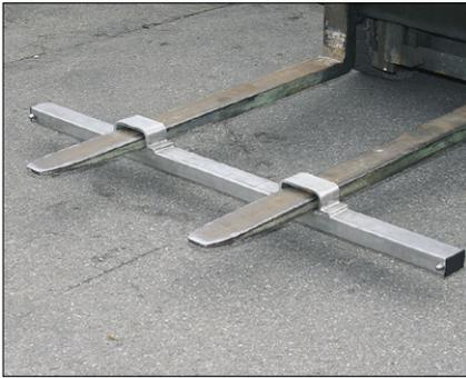
Pour l'enlèvement de pièces ferreuses à l'intérieur (halls industriels) ou à l'extérieur (terrains, chemins, routes, etc...)
