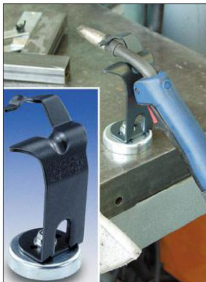
Permet de poser l'appareil à souder très chaud sans risque d'endommager l'établi ou les autres instruments. Le porte-tuyère absorbe la chaleur de la tuyère ; la partie métallique et le pied magnétique jouent le rôle de conducteur et évacuent ainsi rapidement cette chaleur. Aimant de Ø 63 mm avec force de 35 daN et pour une température d'utilisation jusqu'à 200°C.
