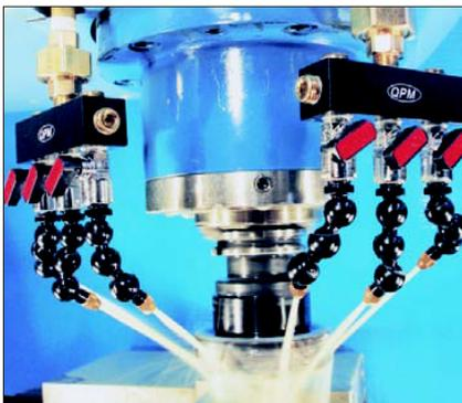
Corps en aluminium anodisé fiche en acier, raccords et nippels en laiton.
