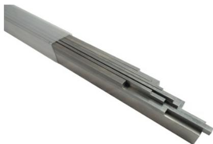
Ce coffret contient 19 barreaux de 500mm de longueur. Il s'agit d'un barreau d'acier "mi-dur" C45 avec une tolérance "de réparation", avec surépaisseur. Intéressant pour la maintenance, cela permet de bien réajuster la clavette lorsque le jeu est devenu trop important. Cette surépaisseur est surtout importante dans la largeur qui sera toujours avec une tolérance zb10. La tolérance pour la hauteur peut différer : zb10 ou h11
