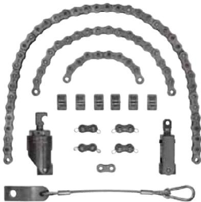
Ce système à grande plage de serrage s'utilise essentiellement pour des pièces cylindriques comme des corps de vannes ou de pompes, des flasques, des pistons, etc..., soit directement sur la table de la machine-outil, soit sur un plateau à trous tarudés. Il permet de répartir la pression et réduit la déformation de la pièce à usiner.
