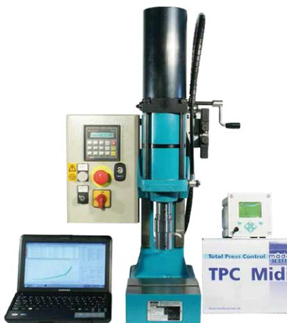
De nos jours, on désire que les opérations de montage et d'assemblage au moyen d'une presse pneumatique ne doivent plus être contrôlées après la production. L'utilisateur exige donc que les paramètres de force et de déplacement définis soient maîtrisés de façon permanente dès le stade de fabrication.
