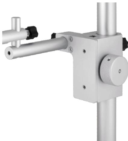
Support à base carrée avec colonne permettant un réglage en hauteur du microscope et une rotation à 360° autour de l'axe horizontal.
