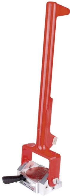
Ce levier massif est une aide très efficace pour l'ajustage et l'alignement de tôles dont les jonctions doivent être soudées au même niveau. Il est muni d'un aimant "On - Off" en Néodymium et d'un support robuste pour effectuer une pression parfaite.
