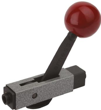
**MATIERE :** corps en acier, peint argenté, pièces intérieures en acier bruni, toutes les pièces soumises à la charge sont trempées, boule en duroplast rouge.
