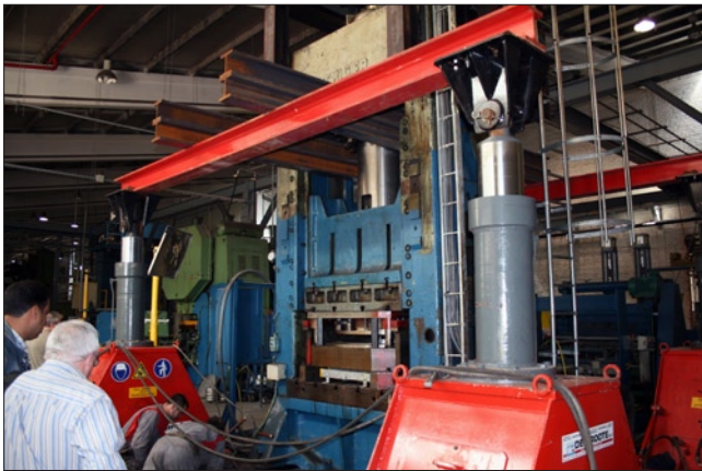
HEFFEN VAN DE PERS MET HYDRAULISCHE HEFCILINDERS
