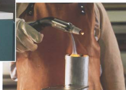
SRF T-2 angeschlossen an einen Schweißbrenner mit integrierten Absaugdüsen – die effektivste Absaugmethode.
